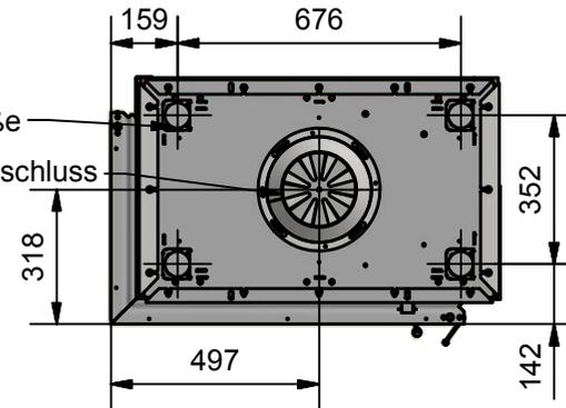
Alle Höhenangaben gelten bei einer Mörtelfugenstärke von 3 mm, einer Fasermattenstärke von 3 mm (im zusammengedrückten Zustand) und vollständig nach unten geschraubtem Grundgestell.
